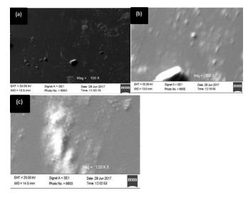
Fig. 2 SEM images of (a)  $FTO/c-TiO_2$ /  $m-TiO_2$ , (b)  $FTO/c-TiO_2/AgNPs@TiO_2/m-TiO_2$ , and (c)  $FTO/c-TiO_2$ /  $m-TiO_2/AgNPs@TiO_2$
